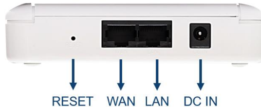
圖、資安防護閘道器設備後端插孔
